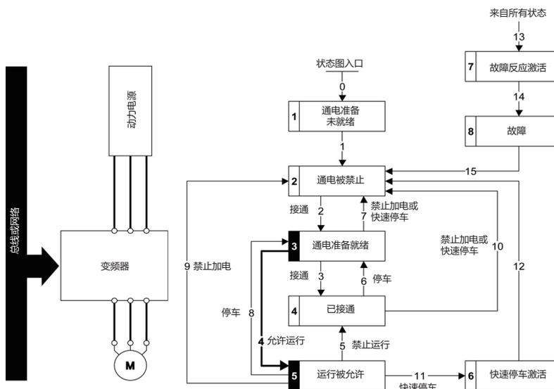
注意：可以，但不一定要先应用3-通电(3 - Switch on)命令，再应用4 -允许运行(4 - Enable Operation)命令，来依次切换到运行状态3-通电准备就绪(3 - Ready to Switch on)、4 - 已通电(4 - Switched on)和5-运行被允许(5 - Operation enabled)。4 - 允许运行(4 - Enable Operation)命令就足够了。
