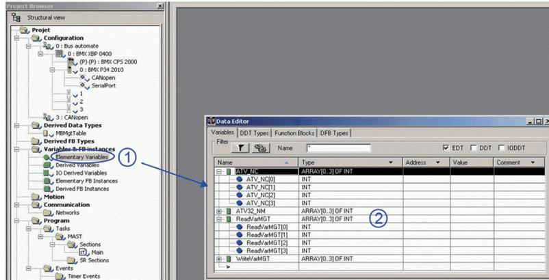
由于所宣称的所有表格均是动态的(没有固定地址), 因此有必要在项目中设置为«Allows dynamic array»和«Directly represented array variables»。必须在«Tool»菜单下的«Project settings»和«Language extensions»窗口中完成参数化。
