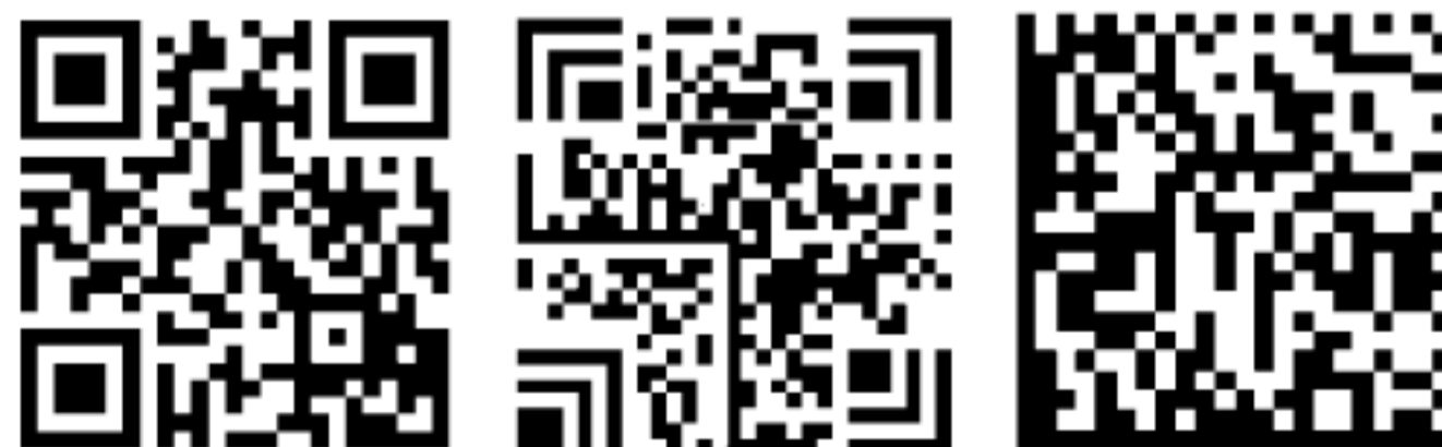
图 A.5 带网址的 Ecode 的 QR 码、汉信码和 Data Matrix 码符号
