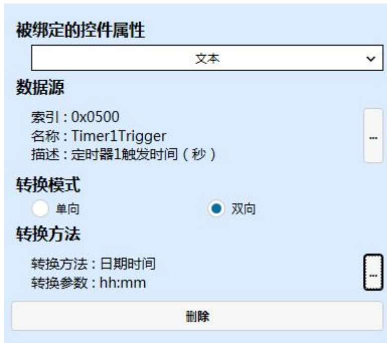
图 3.3 设置定时器时间输入框
