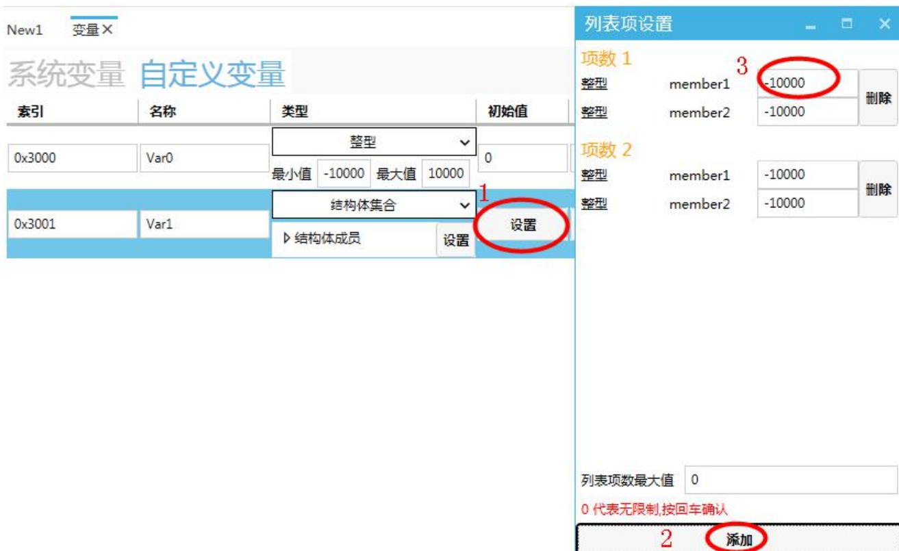
图 3.8 设置结构体集合初始值/模拟值
