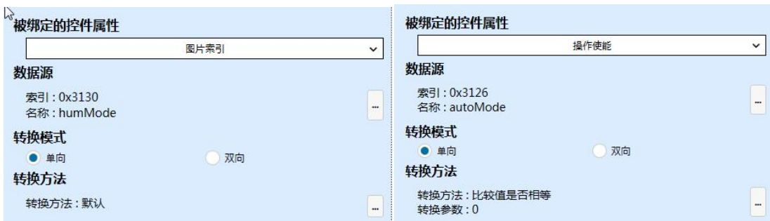
图 6.10 三态多组按键变量绑定
