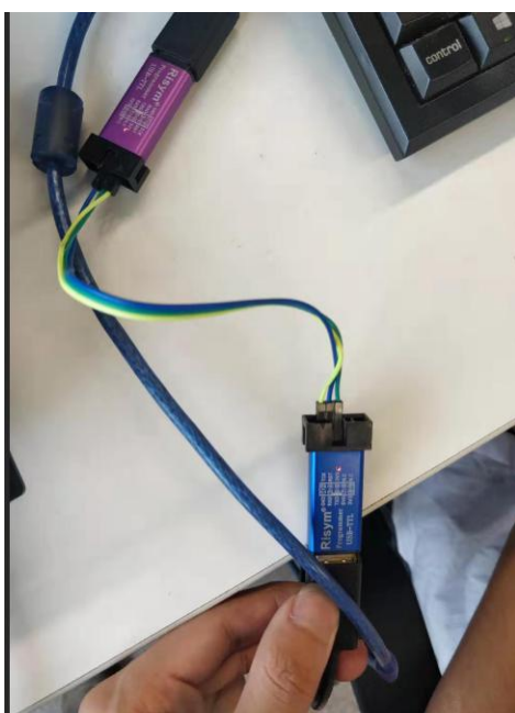
图2.1 串口接线方式
