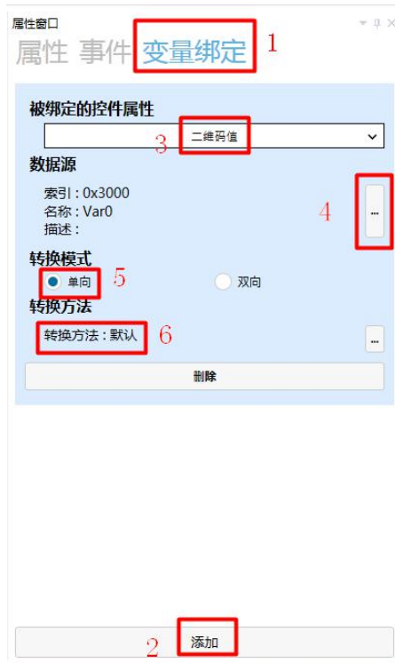
图 4.2 二维码控件变量绑定
