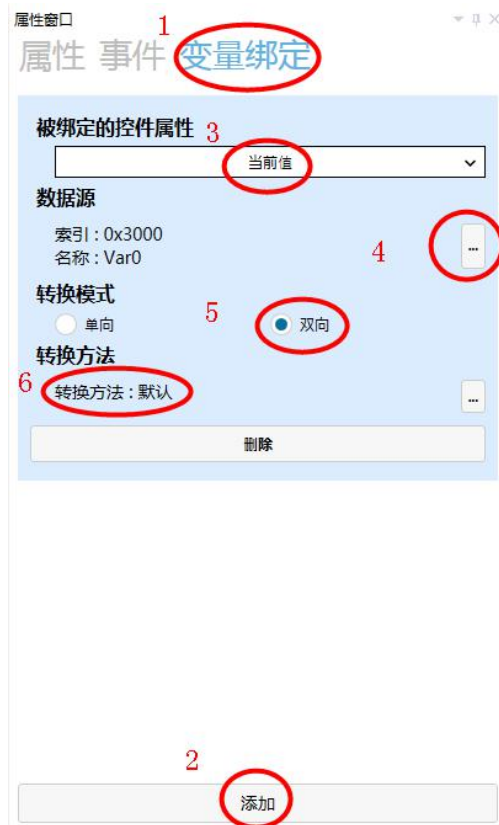
图5.4 滑动条变量绑定
