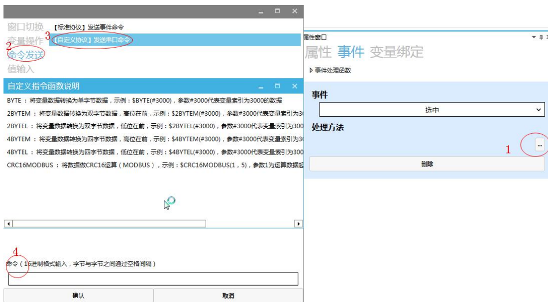
图 4.6 【自定义协议】发送串口命令
