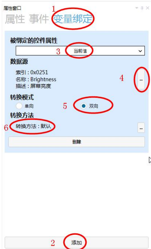
图 5.8 设置滑动条变量绑定
