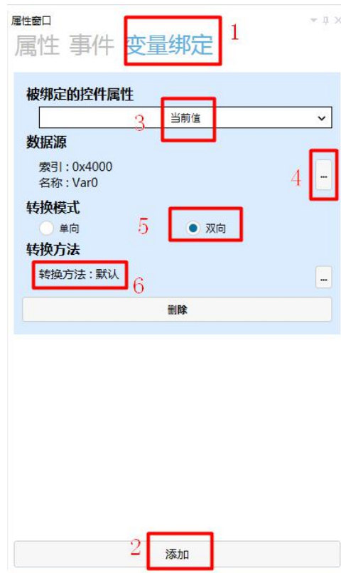
图 5.12 滑动条变量绑定
