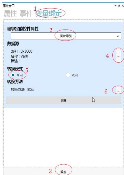
图 5.6 多组按钮变量绑定
