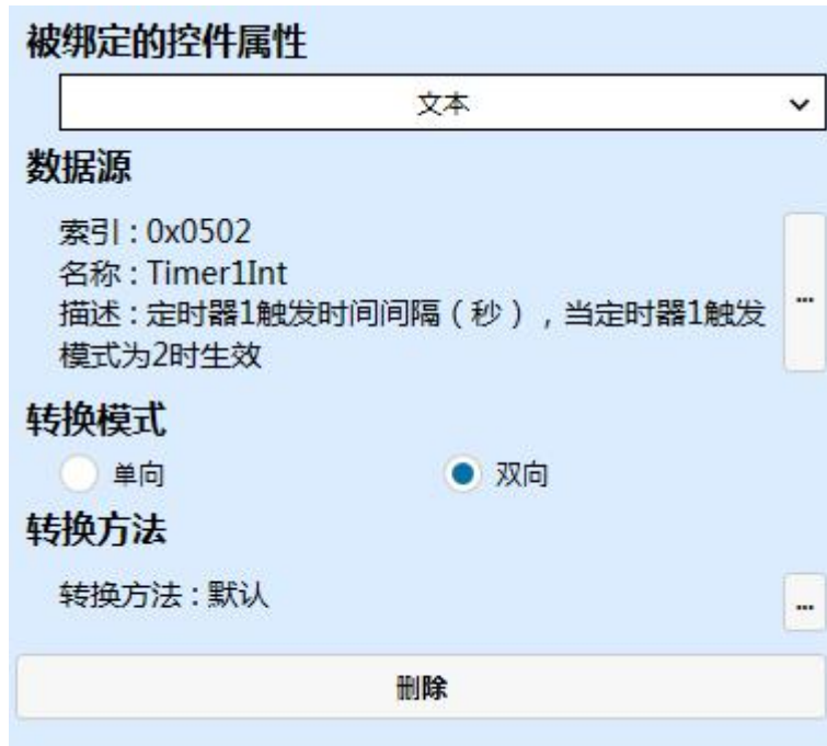
图3.3 设置定时器触发时间间隔输入框
