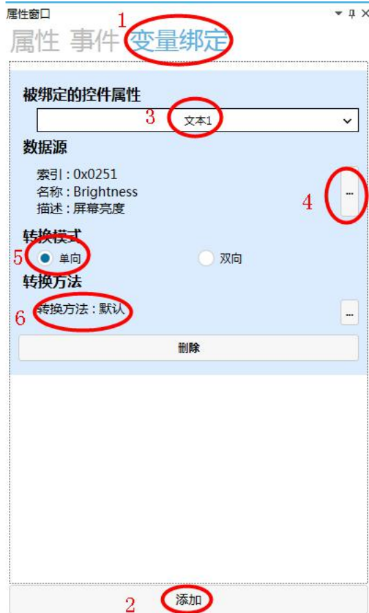
图 5.6 设置文本控件变量绑定
